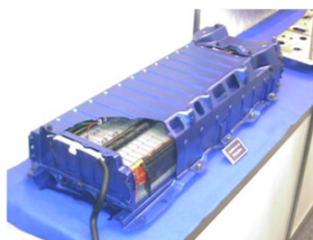
車載用電池電槽 PP/PPE
