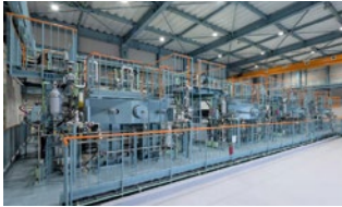
当社川崎製造所の水素製造用アルカリ水電解パイロット試験設備
