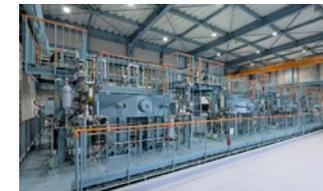
当社川崎製造所の水素製造用アルカリ水電解パイロット試験設備
