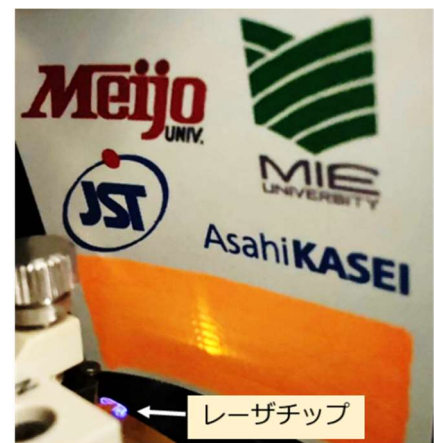
UV-Bレーザーの発振の様子 (目で見えない紫外線を目視するために紙に蛍光体を塗ってレーザー光を照射しています)
