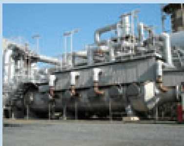
温室効果ガスの一つである亜酸化窒素 (N 2 O) の分解装置 (ナイロン原料の製造工程)
