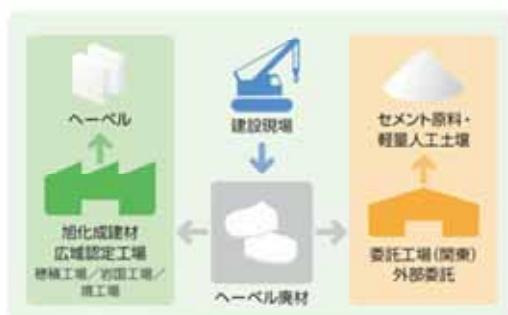
「ペーベルパネル廃材」リサイクルの仕組み
